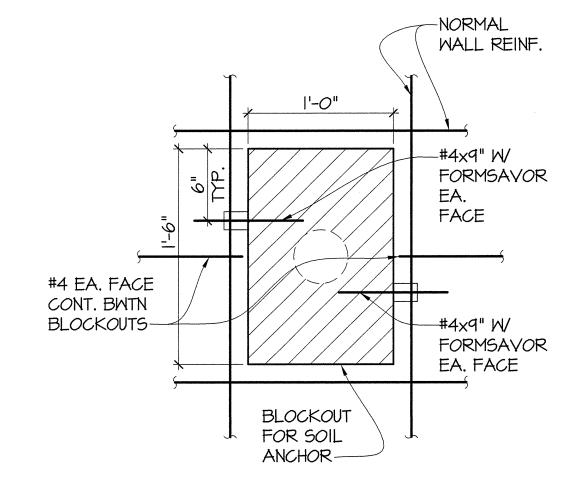
TYPICAL BLOCKOUT DETAIL @ GRID G
