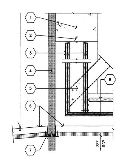
CEILING EXPANSION JOINT AT 2-HOUR TUNNEL
